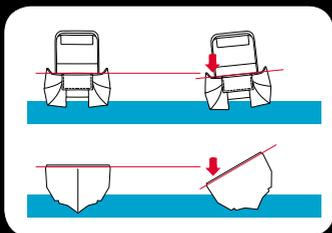
Максимальный наклон полностью загруженной с V-днищем лодки 19,5 градусов, а Alucat катамарана только 10 градусов.
